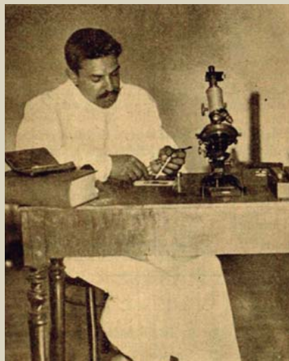
Jerónimo Fernández Domínguez. El autor depositando una gota de disolución en el hematómetro con el aspirador de precisión y seguridad para efectuar el examen microscópico. Escuela de Veterinaria Santiago. 1912 18
